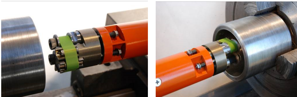
Mikrowygładzenie otworów foliową taśmą ścierną w elementach obrotowych z zastosowaniem głowicy GO-2
